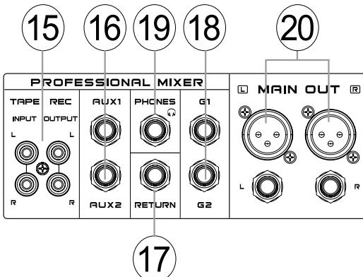
**15.[CD/TAPE INPUT/OUTPUT]** Las entradas TAPE IN (en RCA estéreo) permiten la conexión de dispositivos de reproducción como reproductores de CD, etc. Utilice las salidas TAPE OUT para conectar, por ejemplo, un equipo especial para grabación.
