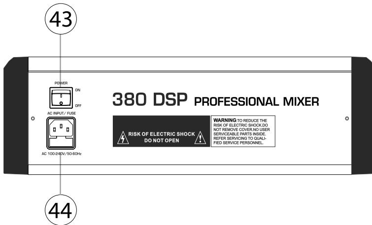
**43.[POWER SWITCH]** Utilice el interruptor de encendido para encender la mezcladora. El interruptor de encendido debe estar siempre en la posición "OFF" cuando no esté conectada la alimentación de la unidad. Para desconectar el equipo de la corriente eléctrica, extraiga el enchufe del cable principal. Al hacer la instalación, asegúrese de que el enchufe sea fácilmente accesible.
