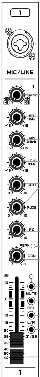
1. **[MIC/LINE]** Entrada mono, conecte un micrófono, un instrumento musical o un dispositivo de audio (reproductor de CD, etc.) al dispositivo. Las tomas admiten tanto conectores XLR como de 1/4" DESBALANCEADOS.
